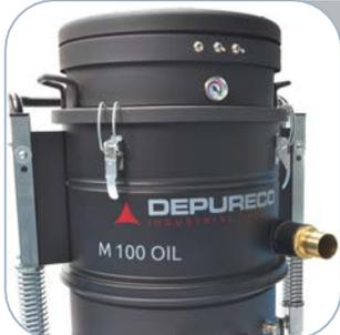
La boca de aspiración está especialmente proyectada para dirigir el material directamente en el contenedor. La entrada es tangencial y soldada a la cámara hay un ciclón metálico robusto. La fricción del aire con el ciclón reduce la velocidad del material que cae fácilmente en el contenedor.
