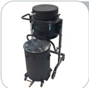
El contenedor está proyectado para separar sólidos y líquidos. Hay una rejilla metálica amovible que separa los trozos metálicos de los lubricantes. Además, al centro de la rejilla hay un sistema flotante y en la parte delantera del contenedor hay un indicador de nivel visivo que permite comprobar el nivel de líquidos adentro.
