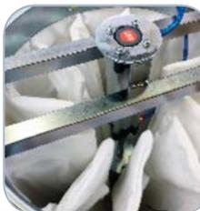
El sistema PSC es un sistema automático de sacudir. Dentro de la cámara del filtro hay un pistón neumático que sacude el filtro cada vez que el operador empuja el botón de activación. En opción es posible instalar un PLC para obtener un ciclo completamente automático.
